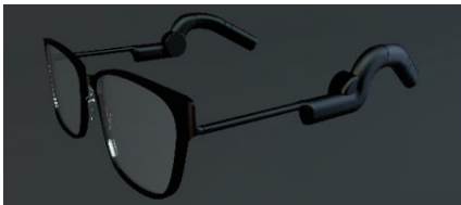
freecle Inc. が開発中の超小型骨伝導スピーカーとマイクを搭載した「メガネ型聴覚デバイス」(プロトタイプ)。
